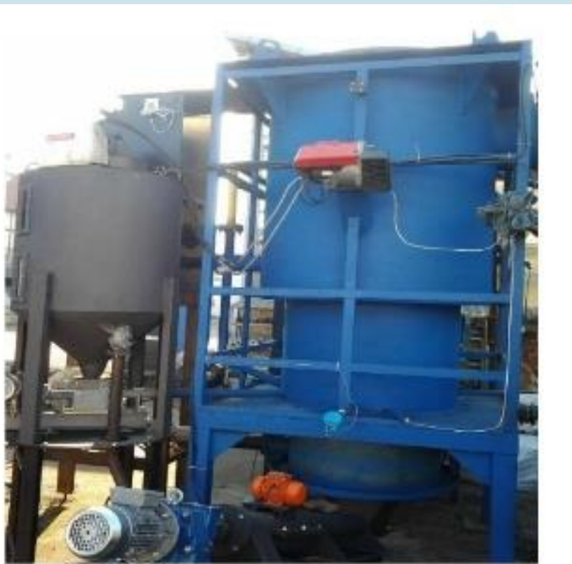
Топка с кипящим слоем и бункером инертного материала
